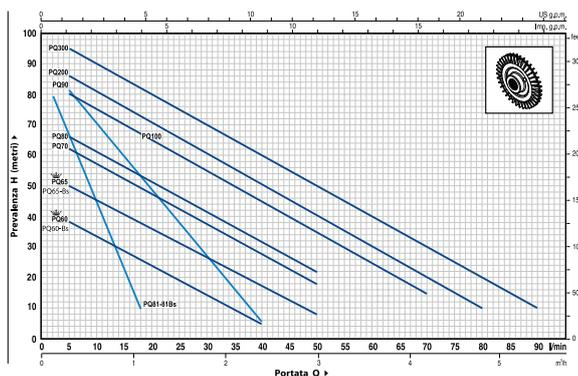
CURVE E DATI DI PRESTAZIONE 50 Hz n=2900 1/min
